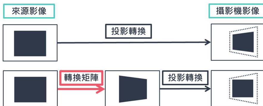
圖 2.4：攝影機/投影機系統之投影失真的校正步驟流程
