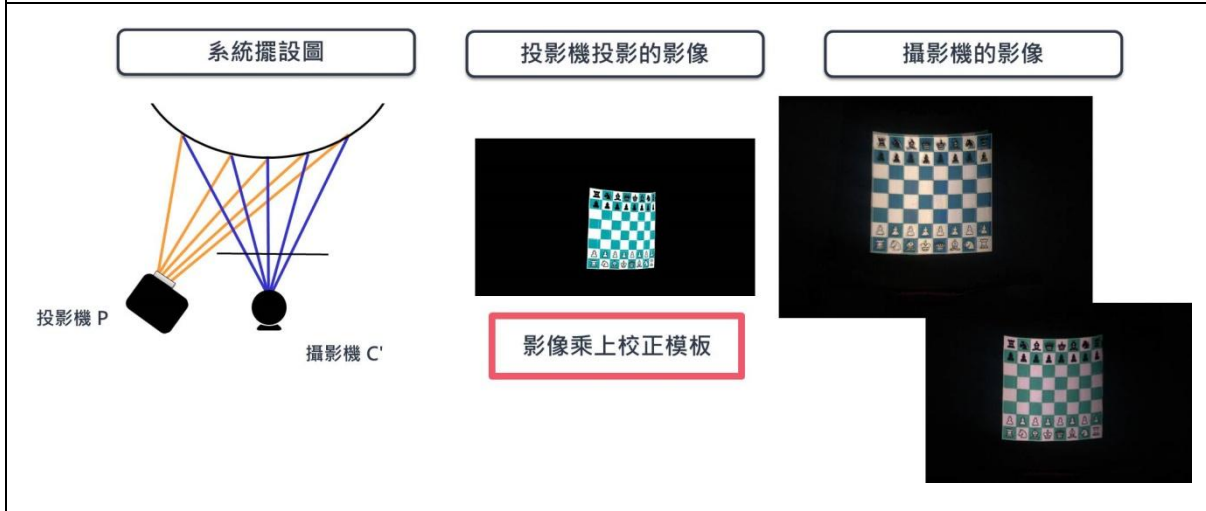
(e) 自動化曲面投影校正成果-彩色棋盤影像
