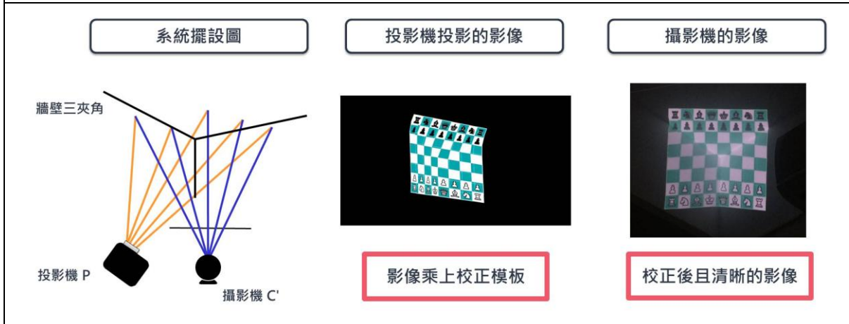
(f) 牆壁三夾角實驗校正後之標準棋盤影像替換成彩色棋盤影像
